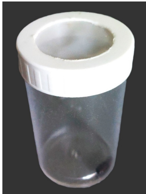
Rajah 1. Bekas plastik universal yang diubahsuai bahagian penutup bagi proses ventilasi
